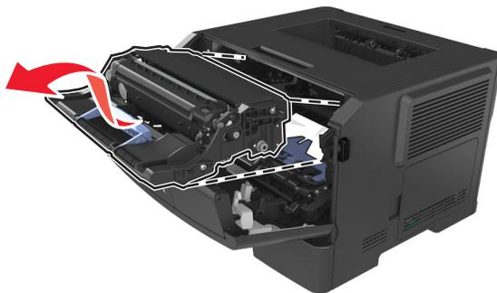
**警告—可能的损坏：** 请勿触摸成像部件下面发亮的蓝色感光鼓。否则会影响以后打印作业的质量。
