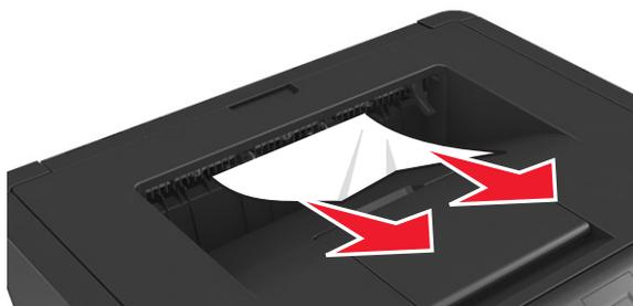
2 从打印机控制面板，选择下一步 > **OK** >清除卡纸，请按“确定” > **OK** 来清除消息并继续打印。
