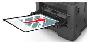
**注意：**当加载 A6 尺寸的纸张时，请确认多功能进纸器扩展板轻轻地靠着纸张的边缘，以使最后几张纸留在原位。
